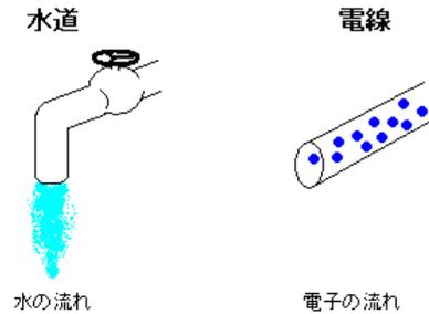
電流は導線内の電子(electron)の流れで、この電子は原子の中の非常に小さい粒子です。
