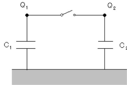
$C_2$  から  $C_1$  に  $q[\mu\text{C}]$  の電荷が移動したと仮定して方程式を立てると, 接続後の両導体の電位は等しいことにより
